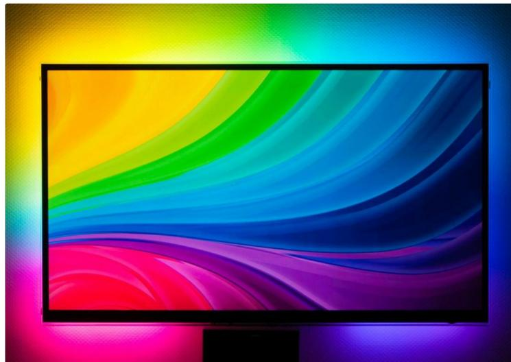
Die Farben der einzelnen LEDs ändern sich automatisch passend zum Bild auf dem TV. Wenn ihr zum Beispiel Fußball guckt, wird die Wand hinter dem TV grün angeleuchtet und es entsteht das Gefühl, dass das Bild auf die Wand vergrößert wird.
