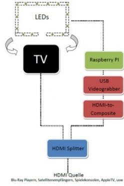
Die Funktionsweise von einem Ambilight ist immer gleich. Alle 4 Rändern des TV Bildes werden analysiert und die passenden Farben auf die LEDs übertragen um das TV Bild künstlich zu erweitern. Die Auswertung der Bildsignale erfolgt bei diesem Ambilight über einen Raspberry Pi.
