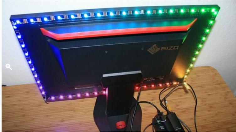
Die LED-Streifen des Insane-Lights werden bei der Bestellung auf die Abmessungen des Monitors zugeschnitten.
